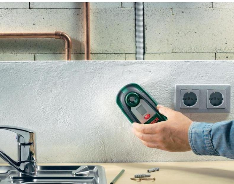
Детектор Bosch PDO 6 оснащен светящимся маркировочным кольцом, которое обеспечивает однозначное разрешение сверления при зеленой индикации и запрещение при красной. Питание прибора осуществляется от щелочной батареи или от аккумулятора, обеспечивающих около 6 часов непрерывной работы. Функция автоматического выключения после 10 минут простоя позволит экономить энергию.
